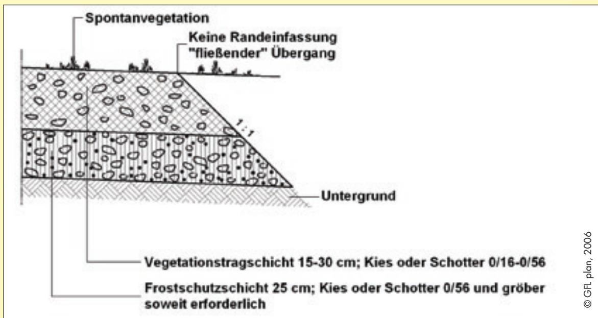
Aufbau einer Schotterdecke in Einschichtbauweise.
