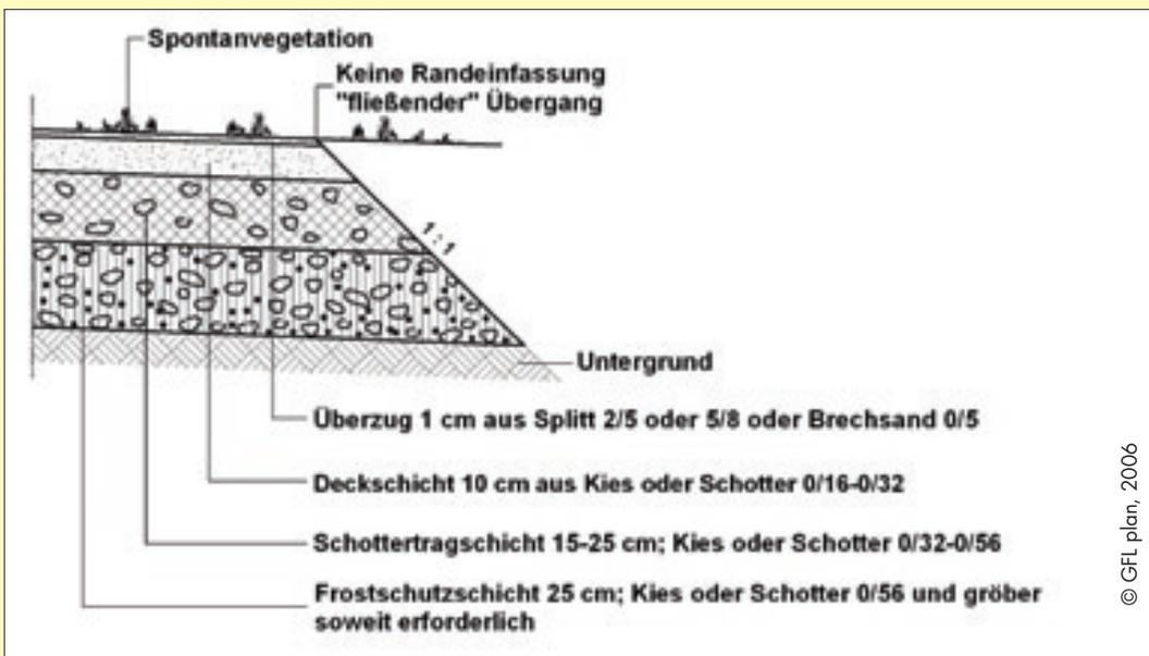
*Aufbau einer Schotterdecke in Mehrschichtbauweise.*
